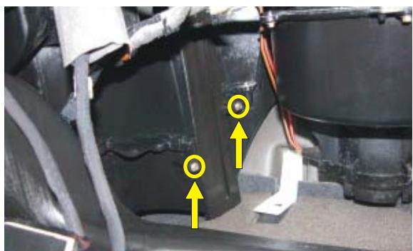
(PL) Odkręcić wkręty pokrywy filtra, usunąć pokrywę
